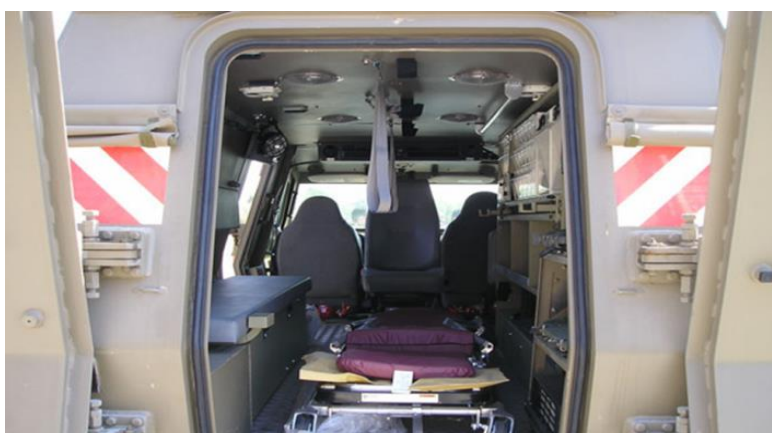
Рисунок 8. – Израильская БММ Dingo, германского производства на шасси Unimog с медицинским отсеком (вид сзади)
