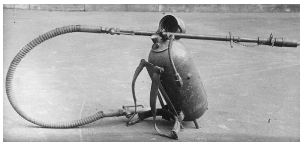
Рисунок 3. – Ранцевый струйно-фугасный огнемёт германии созданный немецким конструктором Фидлером
