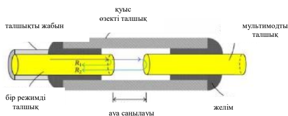
9-сурет. – EFPI сенсорын өлшеу принципі
