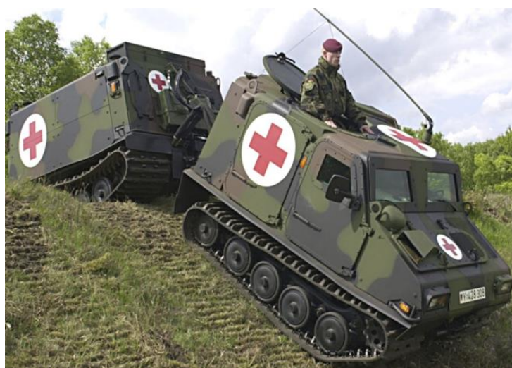
Рисунок 10. – Шведская санитарно-эвакуационная машина Bv-206 S
